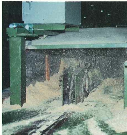
El sistema de aserrío de trozas consiste en la utilización de una sierra circular doble como máquina principal. (Foto: R. Jiménez)
