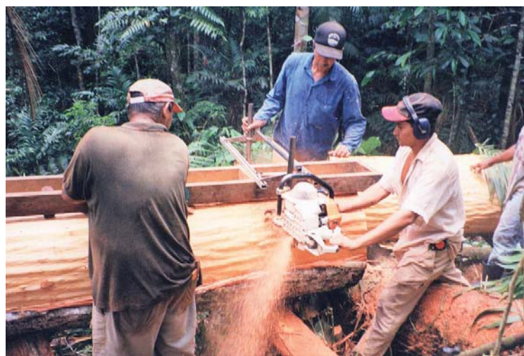
En Toncontín, el aprovechamiento se realiza mediante técnicas de tala dirigida y motosierra con marco para la obtención de madera en bloques
