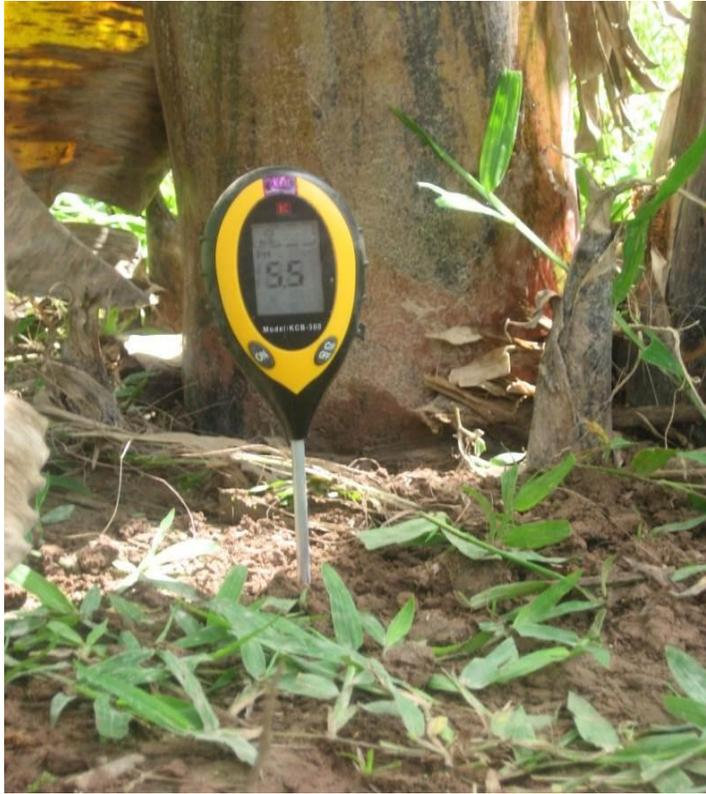
*Figura 12. pH metro digital modelo KCB-300 utilizado para medir la acidez del suelo (pH).*
