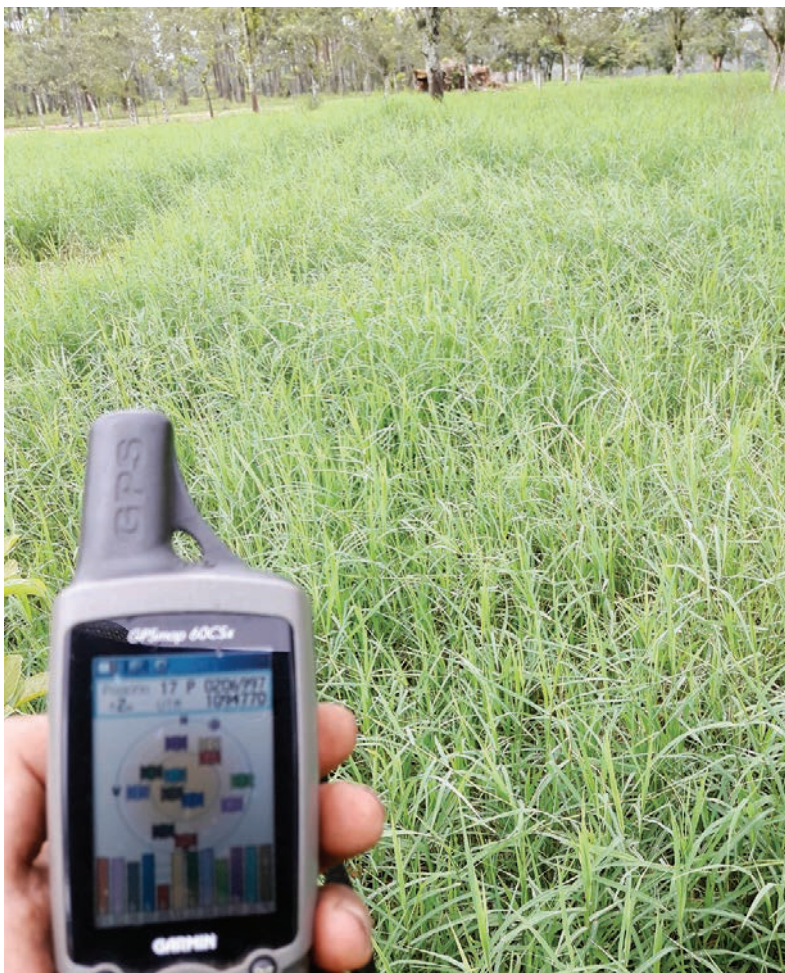
Foto 2. Uso del GPS para medir el área en pasturas y eventualmente definir los puntos donde irán los límites de potreros Crédito: Andres Vega, CATIE
