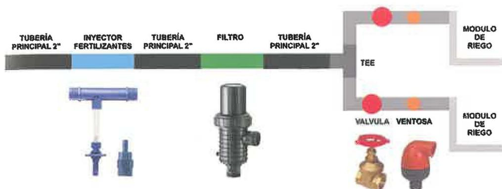
**Figura 4:** Diseño y fotografías del cabezal de riego por goteo.
