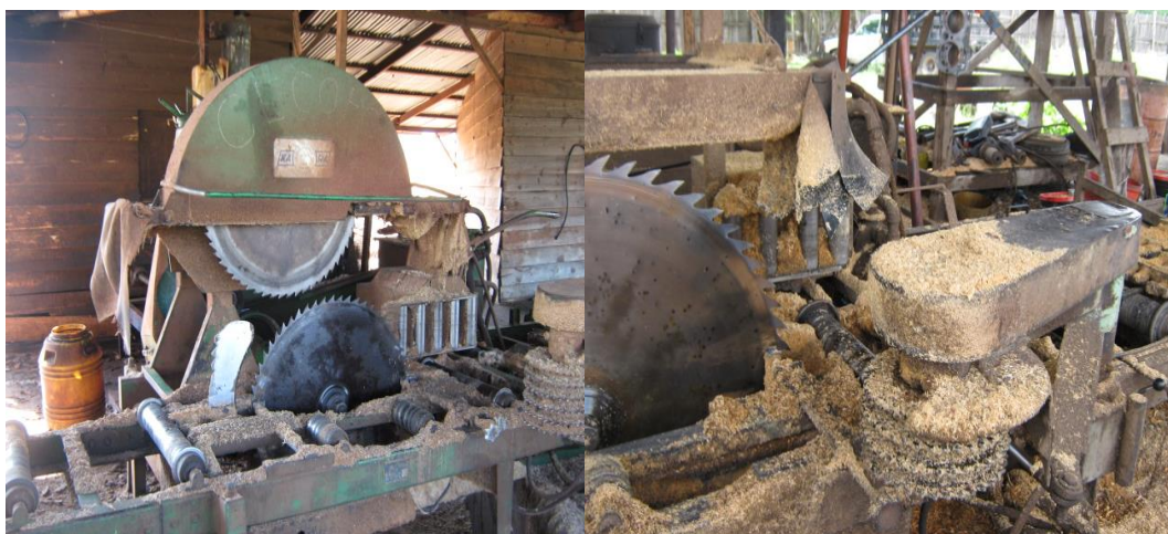
Figura 5. Aserraderos circulares en la región de Nueva Segovia: sierra superior (izquierda) y sierra convencional (derecha)
