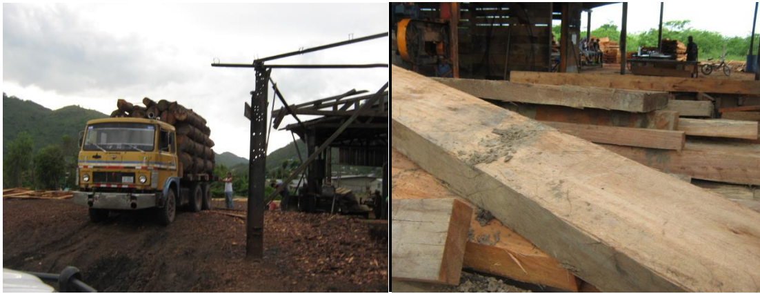
Figura 9. Madera de pino en rollo en Jinotega (izquierda) y madera semidura en timber motoaserrado (derecha) para la industria de aserrío
