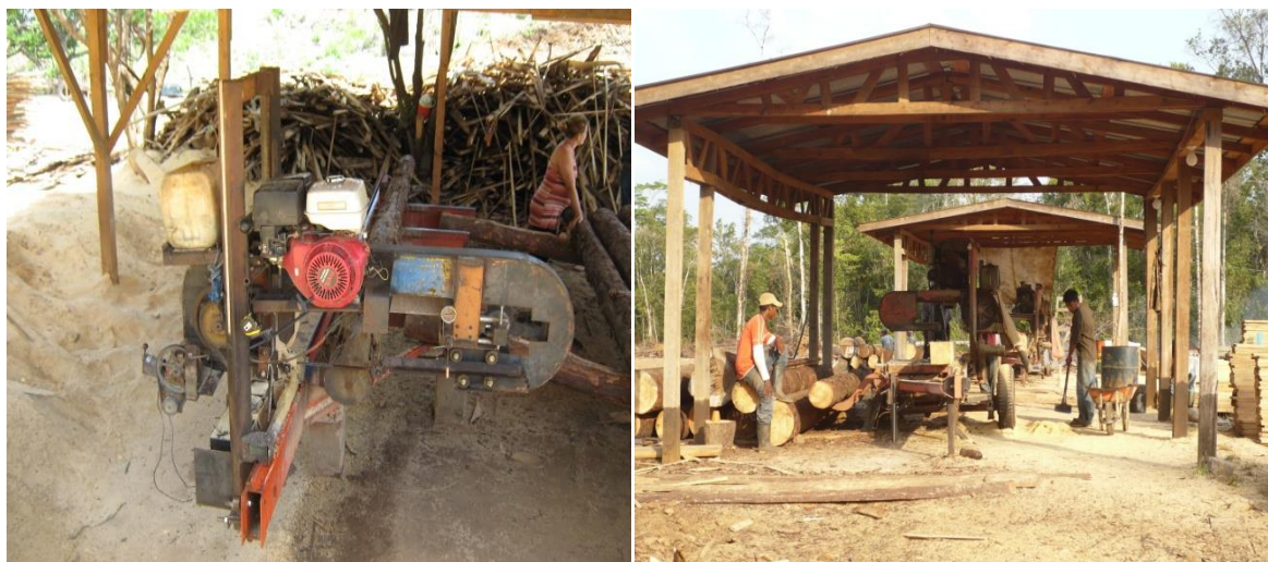
Figura 7. Aserraderos portátiles sinfín en la región de Matagalpa (izquierda) y RAAN (derecha)
