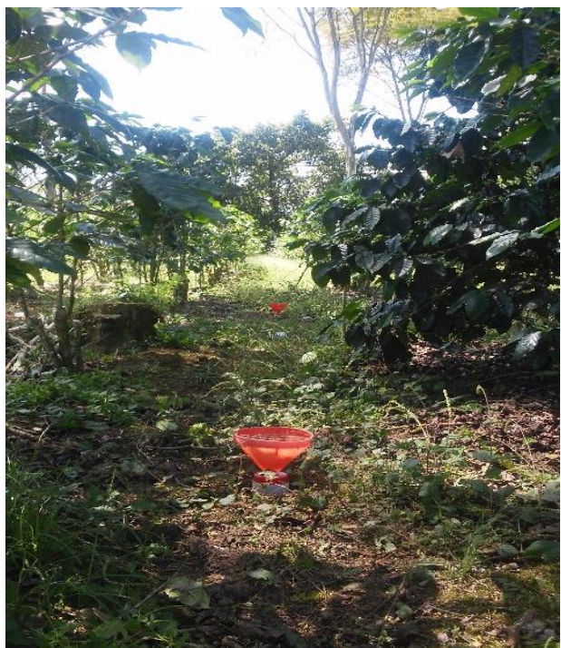
Anexo 7. Trampas utilizadas para evaluar el lavado de esporas a través de la lluvia en las plantas de café en el ensayo agroforestal en CATIE, Turrialba, Costa Rica, 2 016
