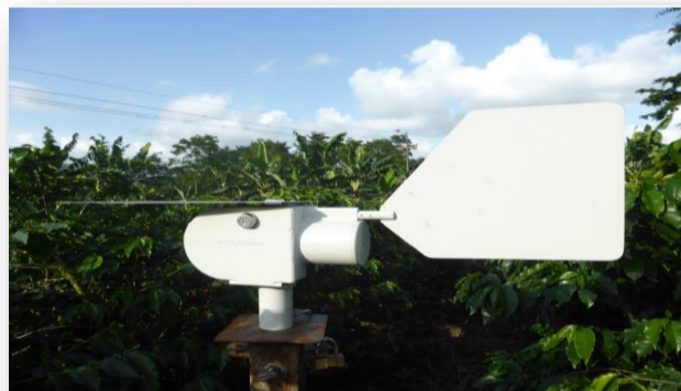
Figura 12. Trampa de succión para esporas tipo Burkard®. Fuente: (Merle 2014).
