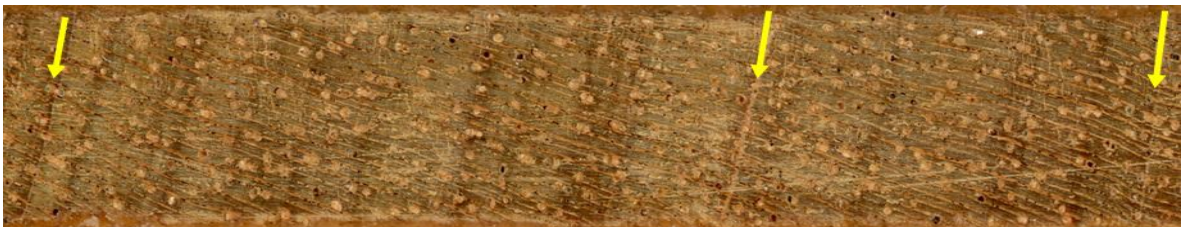
Fig. 3. Imagen transversal de la muestra Lay33-A de Carapa guianensis (14 mp de resolución), en la que se señala con flechas amarillas el parénquima terminal que define cada anillo. Las bandas con coloración más oscura representan la madera tardía y las claras la madera temprana; esta disposición de la madera temprana y tardía en un mismo anillo insta la idea de dos y tres años en un anillo de crecimiento.
