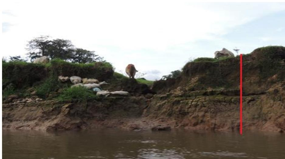
Figura 9. Erosión en la orilla de los canales y bajo nivel de agua en los canales de navegación.
