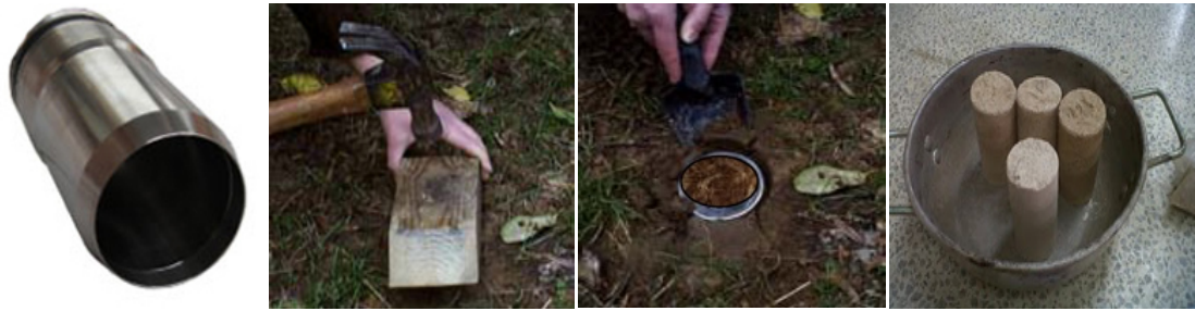
Figura 7. Análisis de suelos utilizando el método de cilindros.
