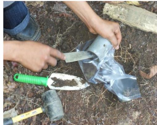
Fotografía No.2: Extracción del suelo del cilindro.
