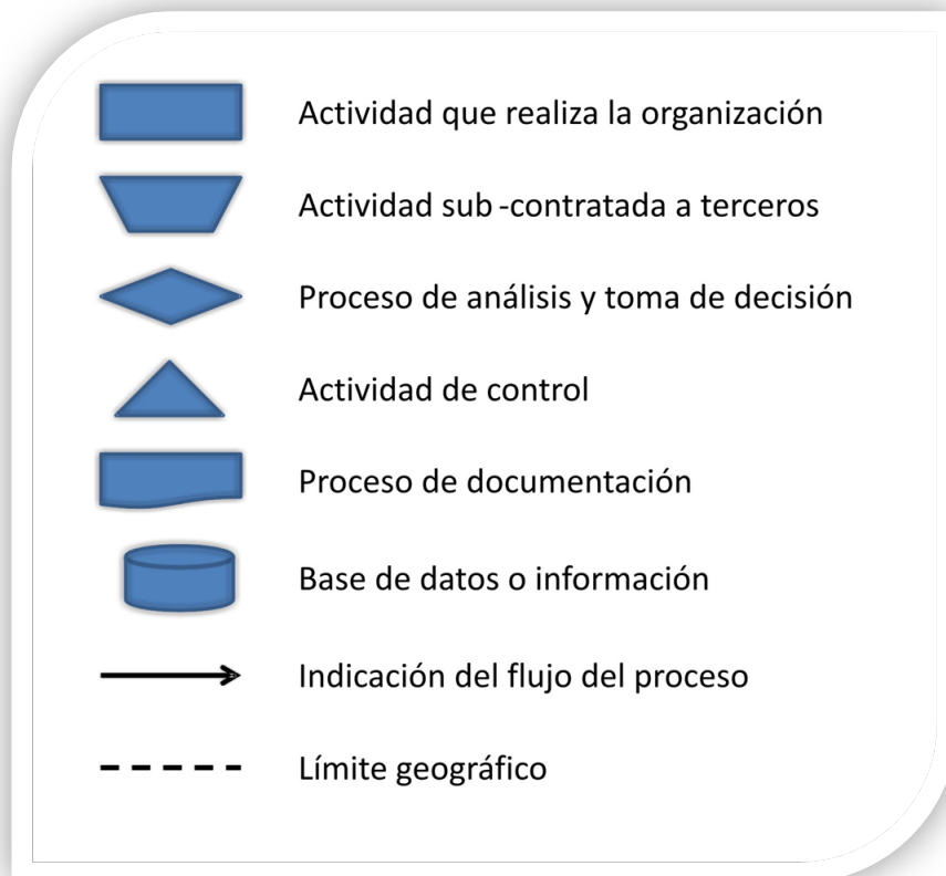
Figura 5. Símbolos para la construcción de un diagrama de flujo del proceso productivo.
