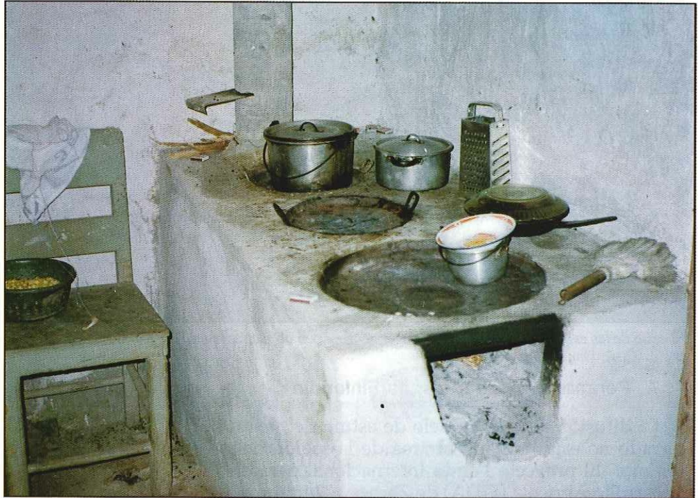
Se han fabricado 4 300 estufas Finlandia que muestran un ahorro promedio del 40% de leña. (Foto: C. A. Domínguez).
