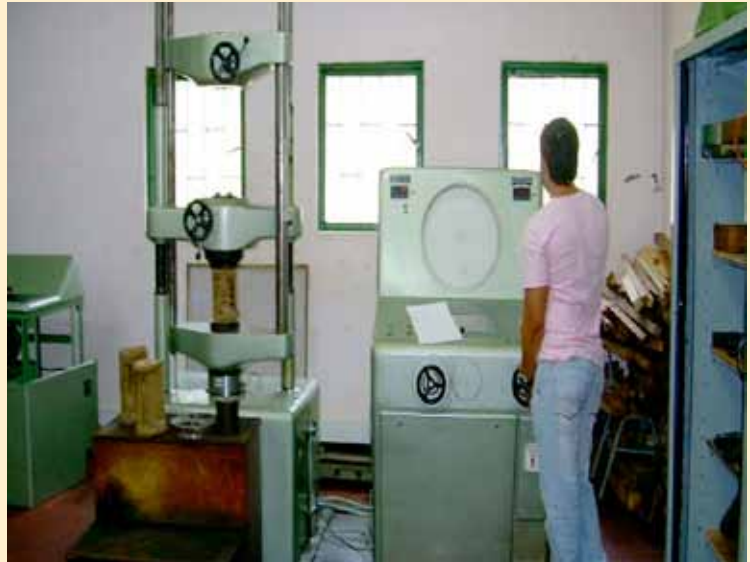
Figura 3. Máquina universal de ensayos WPM ZD 40, para determinar la resistencia al corte
