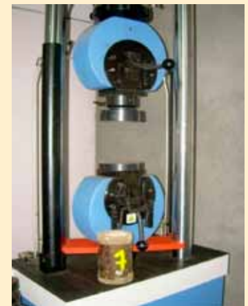
Figura 4. Máquina universal de ensayos Mod. UMIB-600-SW, para determinar la resistencia a la compresión
