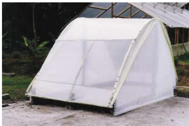
**Figura 1.** Secador solar parabólico experimental modificado, con muselina en sus extremos y bordes laterales para evitar el escape de broca (foto: Moisés Vélez, Cenicafé).
