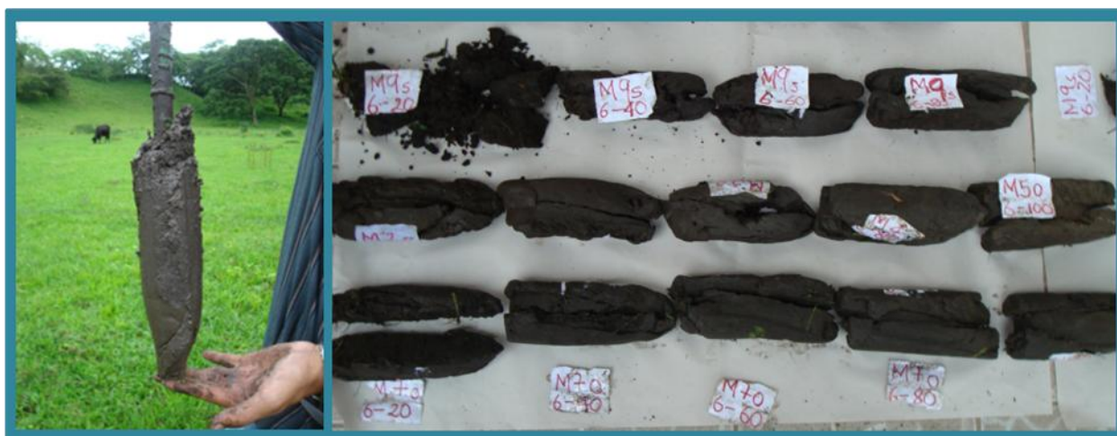
Figura 3. Extracción de suelo utilizando barreno
