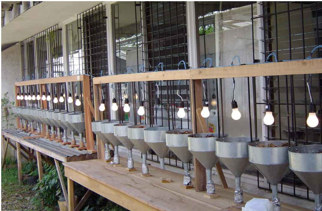
Figura 3. Arreglo de los embudos de Berlese-Tüllgren para la extracción de los colémbolos.
