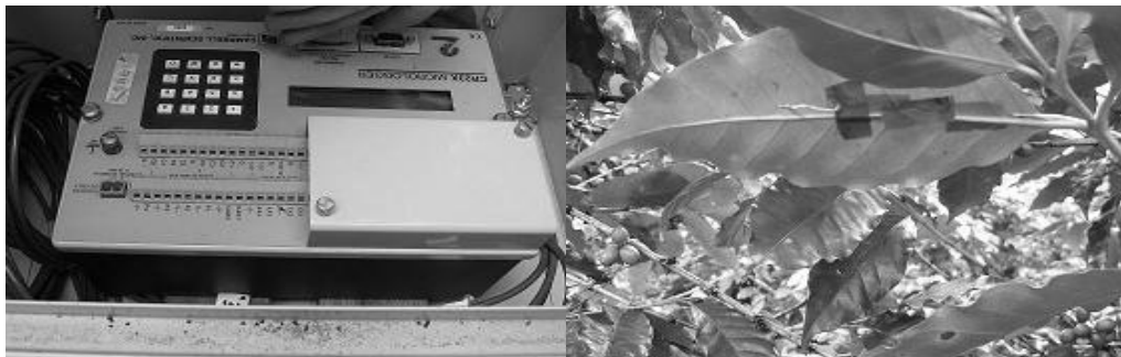
Figura 14. Data logger Campbell y sensor de temperatura de hoja instalado en campo.
