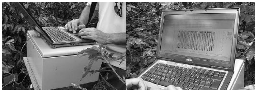
Figura 15. Recopilando información de los data logger Hobo y Campbell.
