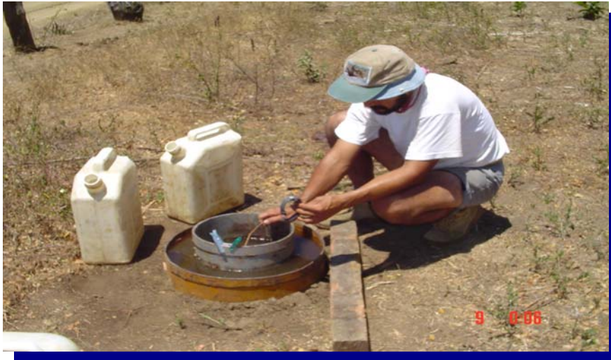
Figura 3. Ilustración del método de anillos concéntricos para la determinación de la capacidad de infiltración
