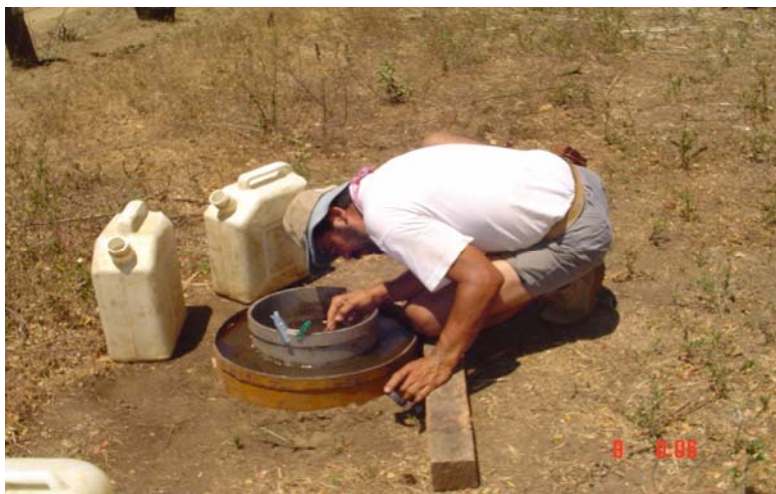
Figura 4. Ilustración sobre el uso y medición de los cilindros infiltrómetros
