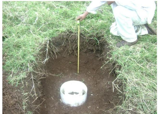
Prueba de infiltración a 50 cm de profundidad
