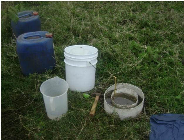
Prueba de infiltración de doble anillo a 5 cm.
