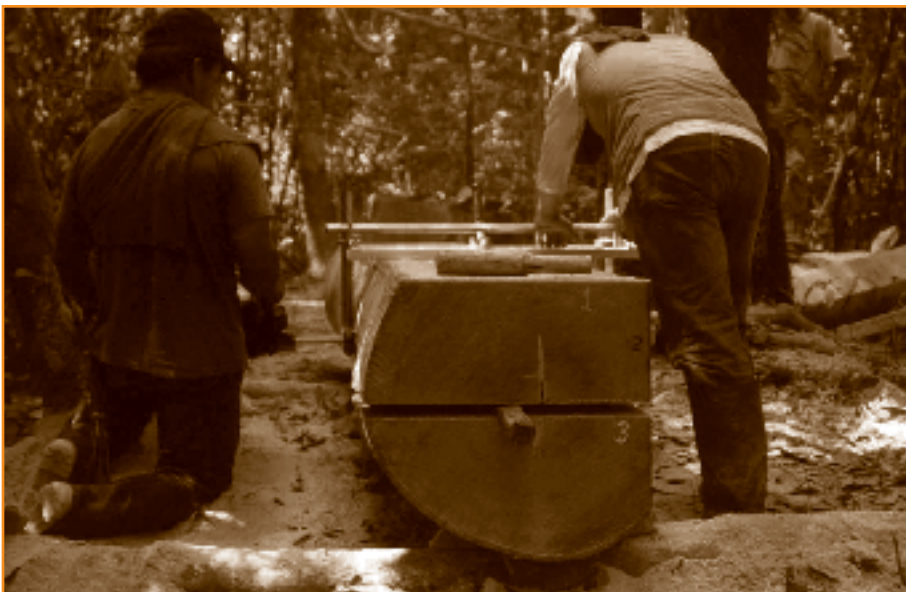
Foto 9.13 Avance del tercer corte. Se observa el uso de cuñas para evitar el prensado de la cadena.
