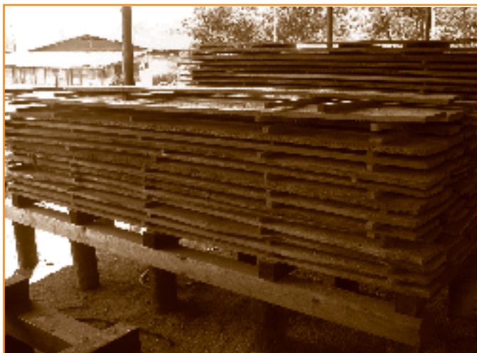
Foto 9.20 Apilado en tarimas con un excelente aislamiento del suelo
