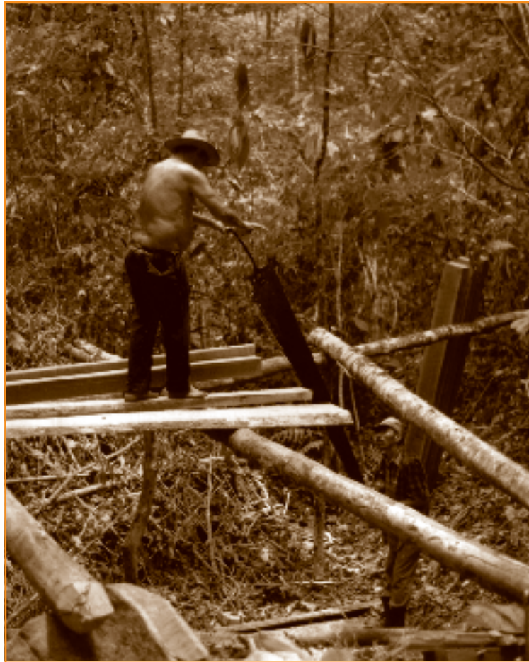
Foto 8.5 Aserrío con sierra de viento en Toncontín, La Ceiba, Honduras. Nótese la cantidad de fustes requeridos para la construcción del banco de aserrío.
