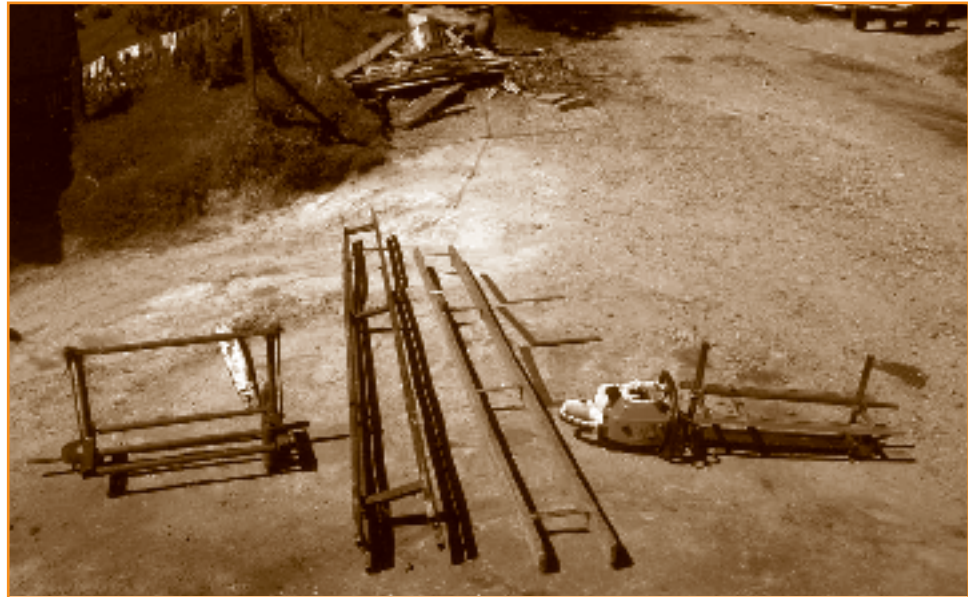
Foto 9.1 Equipo básico para el aserrío: motosierras, marcos, codales y escuadras
