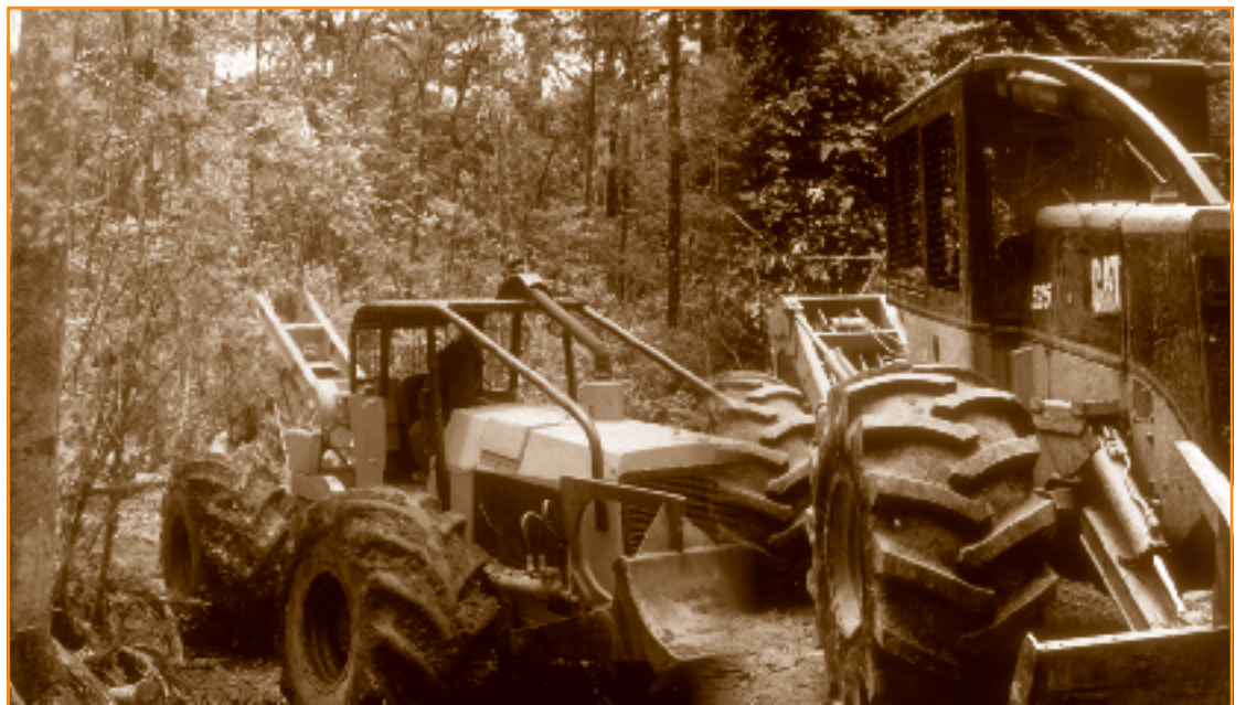
Fotos 6.4 Tractor articulado. Nótese el diseño, llantas, pala y arco maderero.
