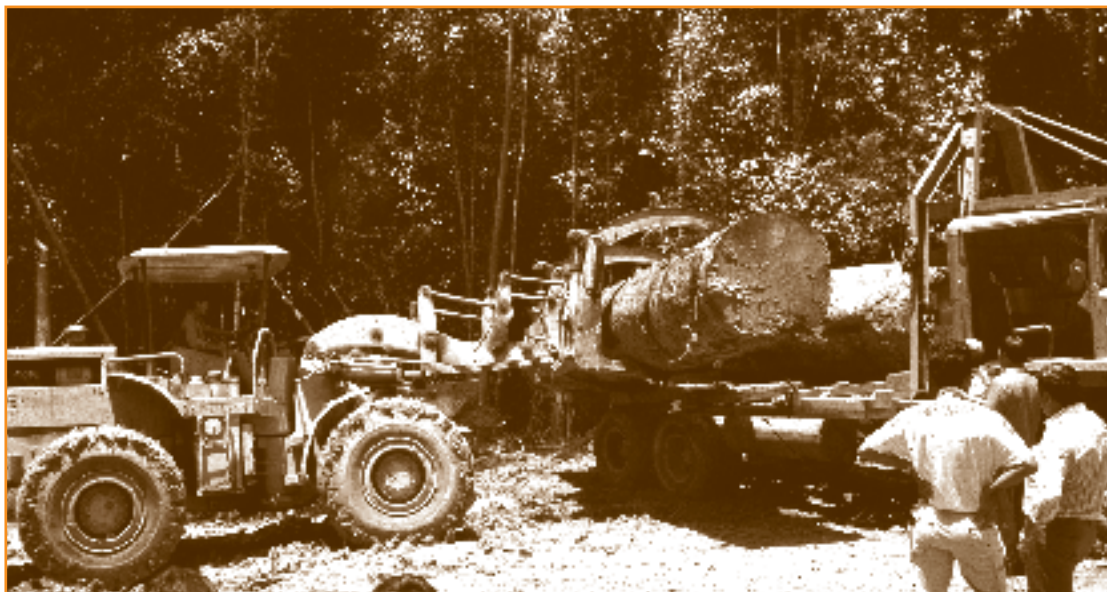
Foto 7.4 Cargador frontal en plena actividad de carga. Es la máquina más eficiente para estas labores.
