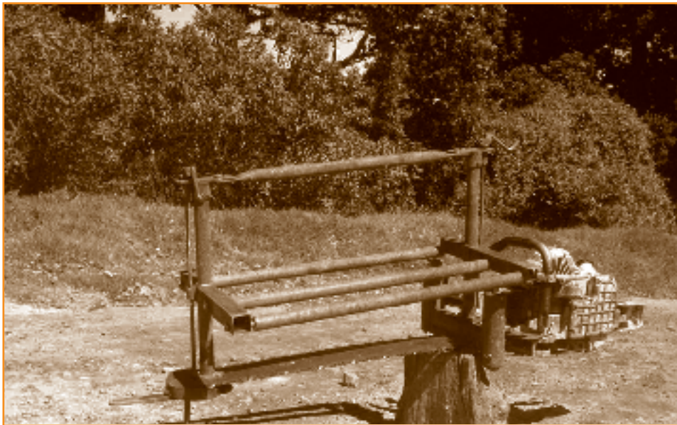
Foto 9.2 Marco de rodillos y motosierra acoplada
