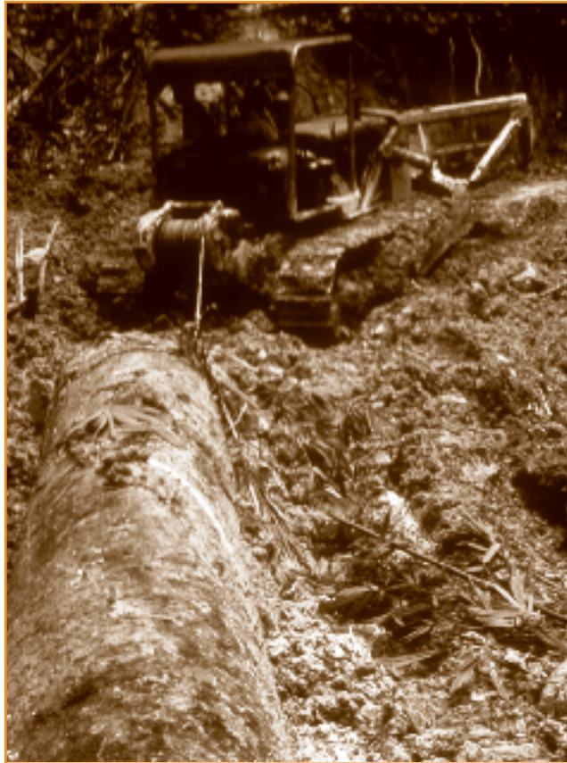
Foto 6.2 Posición de la extracción con tractor de oruga. Nótese el wincheo y la pala levantada.
