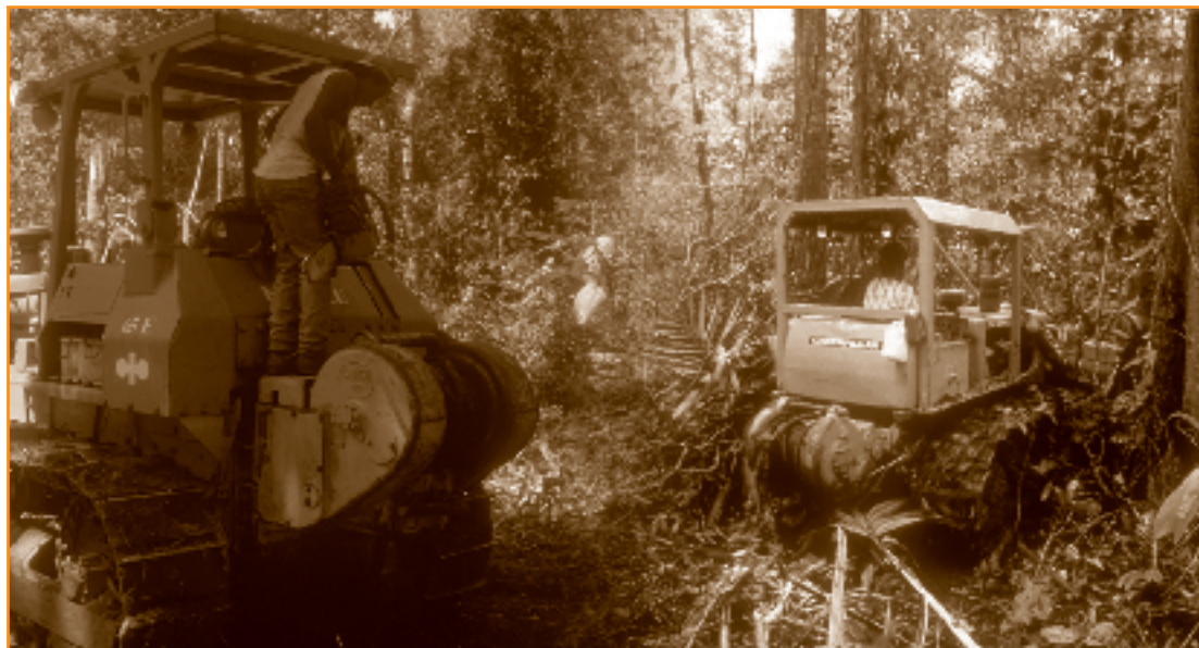
Fotos 6.1 Tractor de orugas. En Centroamérica esta máquina se utiliza mucho en la construcción de caminos, arrastre de madera y otras actividades propias del aprovechamiento.
