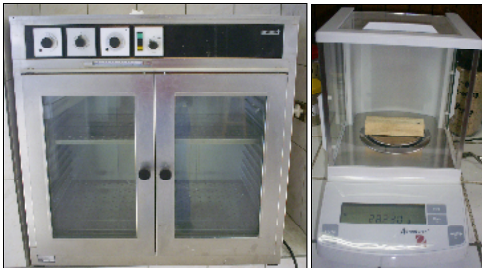
Figura 14. Horno y balanza de precisión para la determinación de contenido de humedad.
