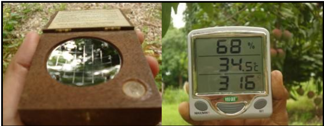
Figura 11. Densiómetro (izq.) e higrómetro (der.) utilizado para la medición de cobertura vegetal y humedad relativa
