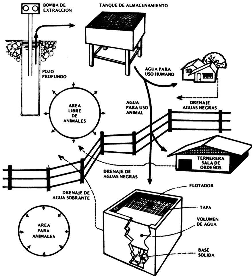
Figura 2. Sistema de manejo sanitario del agua obtenida de un pozo profundo.
