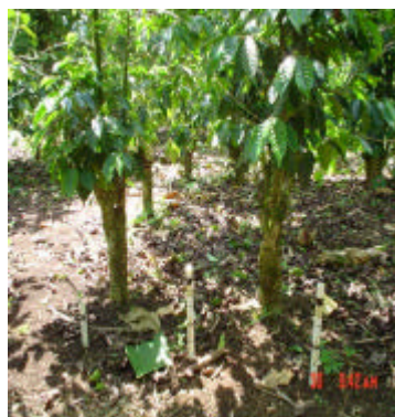
Foto 5. Lisímetros de cápsula de cerámica instalados en el campo a tres profundidades (30, 60 y 120 cm) para medir pérdidas de nitratos del suelo por lixiviación. Izquierda: Parcela con restitución de residuos; Derecha: Parcelas sin restitución de residuos. (Foto V.H. Arana).
