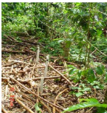
Foto 5. Lisímetros de cápsula de cerámica instalados en el campo a tres profundidades (30, 60 y 120 cm) para medir pérdidas de nitratos del suelo por lixiviación. Izquierda: Parcela con restitución de residuos; Derecha: Parcelas sin restitución de residuos. (Foto V.H. Arana).
