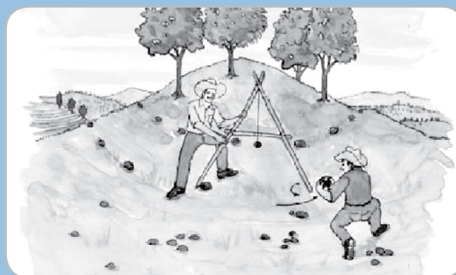
Utilización de un nivel en “A”.
