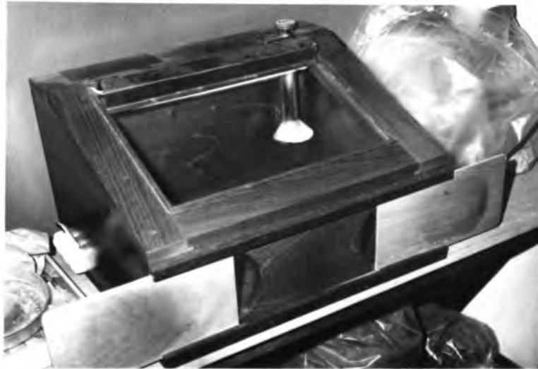
FIGURA 6. Cámara de aislamiento. Abajo, las puertas corredizas para introducir las manos. En el interior se observa el tubo de escape de calor.
