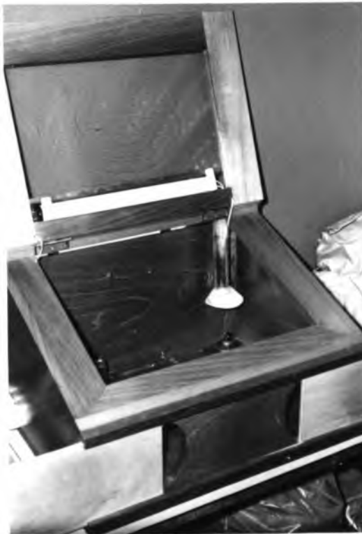
FIGURA 7. Cámara de aislamiento con la tapa abierta. En el interior, la lámpara de alcohol. Obsérvese la bomba fluorescente que ilumina la cámara. Debajo del borde interior, los tubos germicidas.
