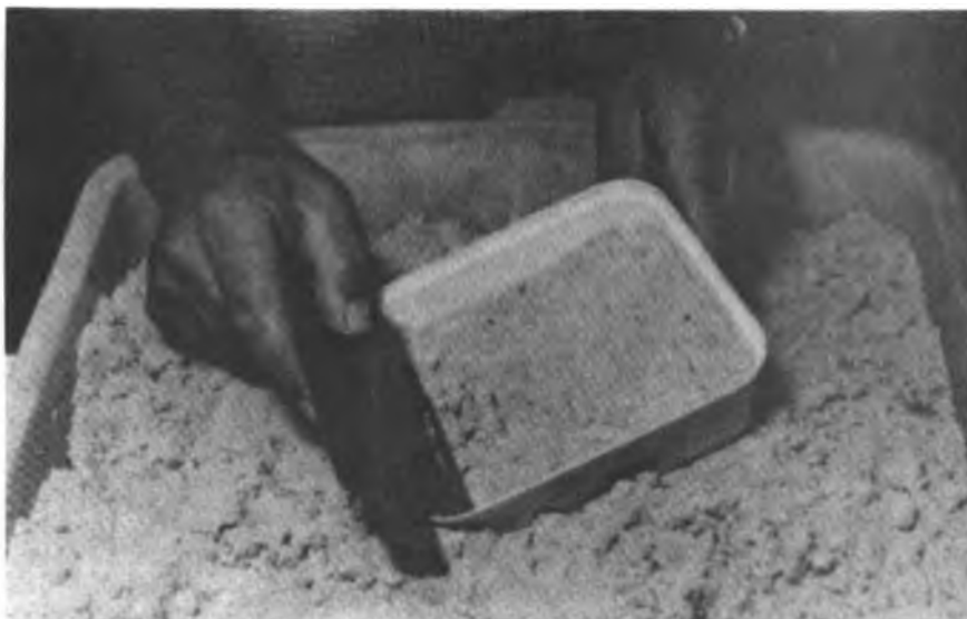
Figura 28. El recipiente se llena con arena húmeda y se nivela con la parte larga de raspador.
