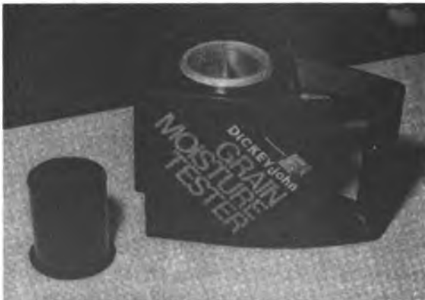
Figura 7. Medidor de humedad rápido portátil operado con batería.
