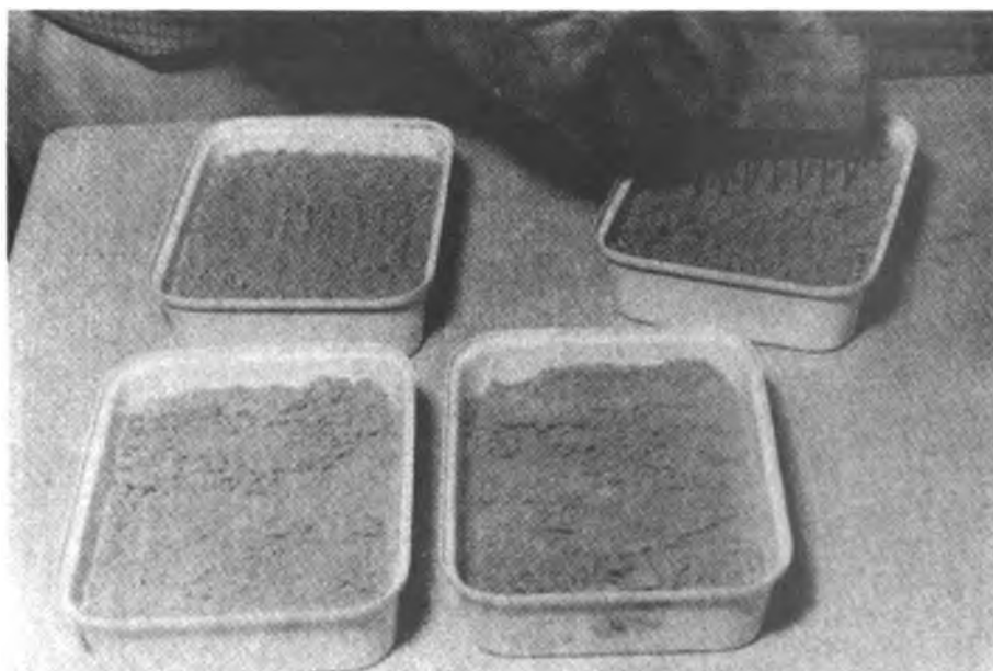
Figura 28. El recipiente se llena con arena húmeda y se nivela con la parte larga de raspador.
