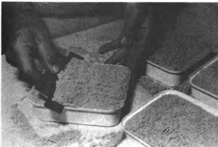
Figura 36. El exceso de arena se elimina con la parte corta del raspador.
