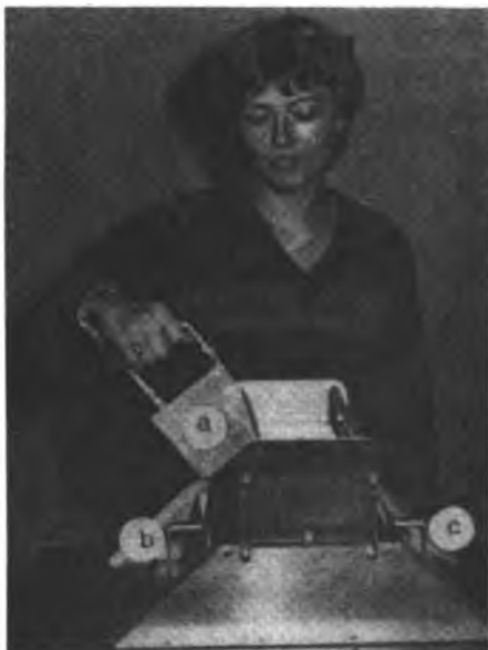
Figura 8. Separador de suelo Se muestra la primera de una serie de separaciones.
