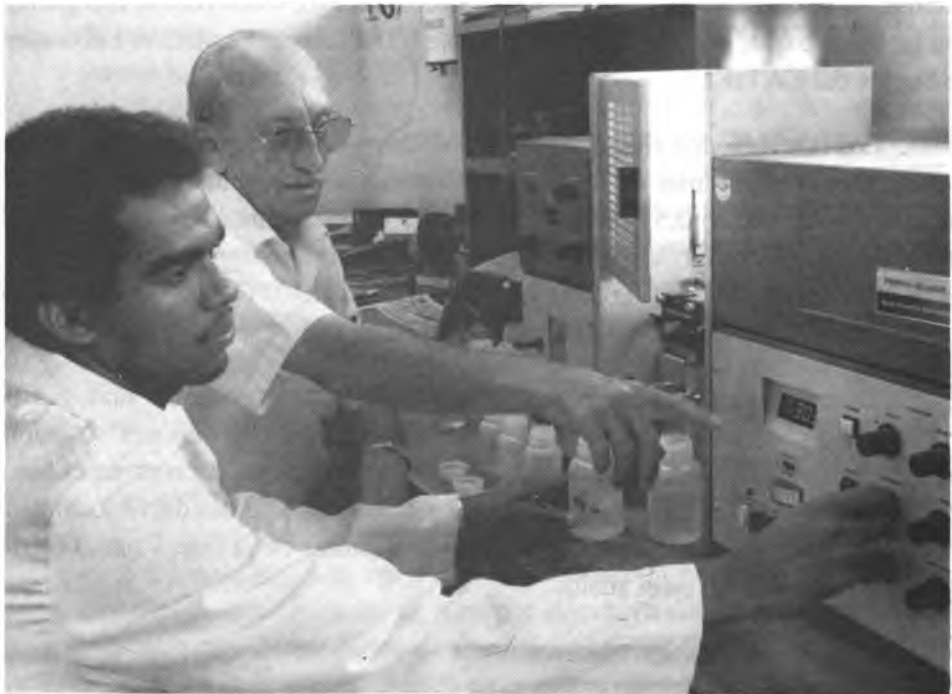
Determinación de potasio por espectrofotometría de absorción atómica, para conocer los requerimientos de este mineral en los cultivos.
