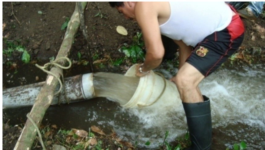
Figura 8. Cálculo del aforo de salida mediante el método de aforo volumétrico
