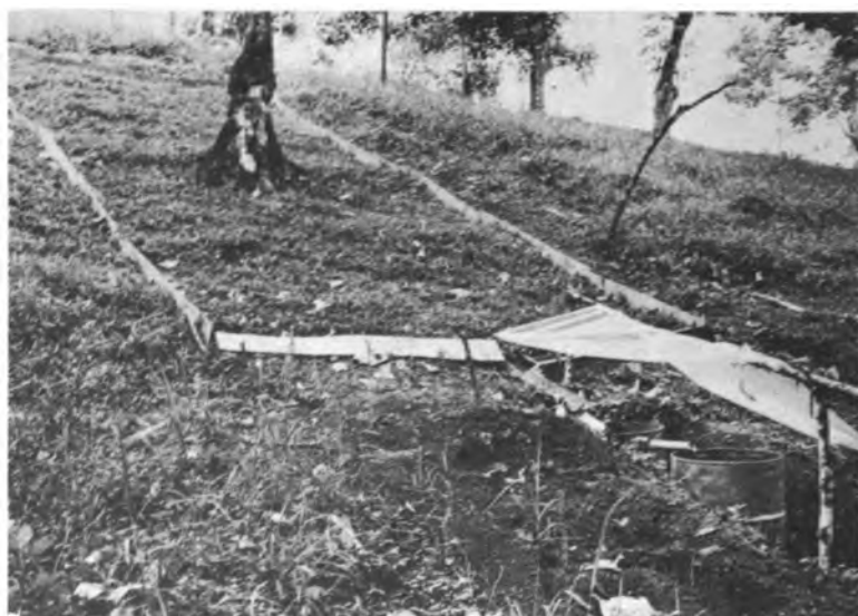
Figura 7.3e.: Parcela de medición de esorrentía en un potrero. La Suiza, Turrialba.
