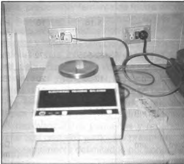
Foto 4.2 Pesaje de probeta utilizada en determinación de Propiedades Físicas de AGELI ( Laguncularia racemosa )
