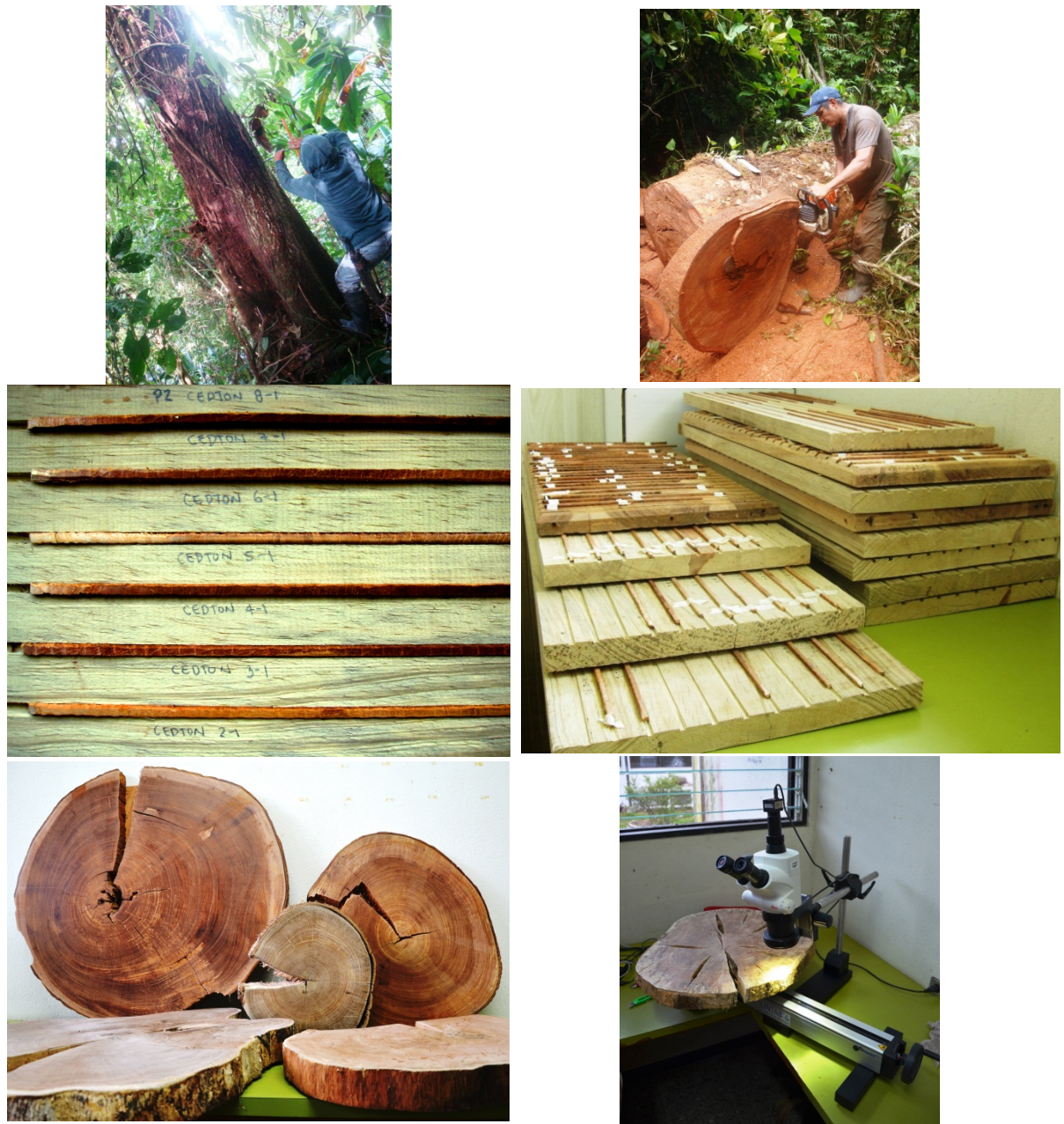
Figura 5: Superior izquierda: Extracción de un núcleo en un individuo de C. tonduzii . Superior derecha: Corte de sección transversal de un individuo de C. guianensis . Centro izquierda y derecha: Soportes de madera para muestras de barreno de incremento. Inferior izquierda: Secciones transversales colectadas en la investigación, las dos más grandes al fondo son de C. guianensis y las restantes son de Q. costaricensis . Inferior derecha: Plataforma de medición Lintab 6.
