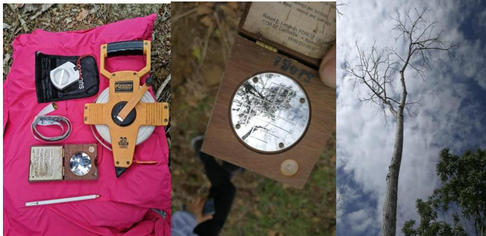
Imagen 2. Medición de altura, DAP y porcentaje de sombra mediante densiómetro esférico y aplicación HabitAp
