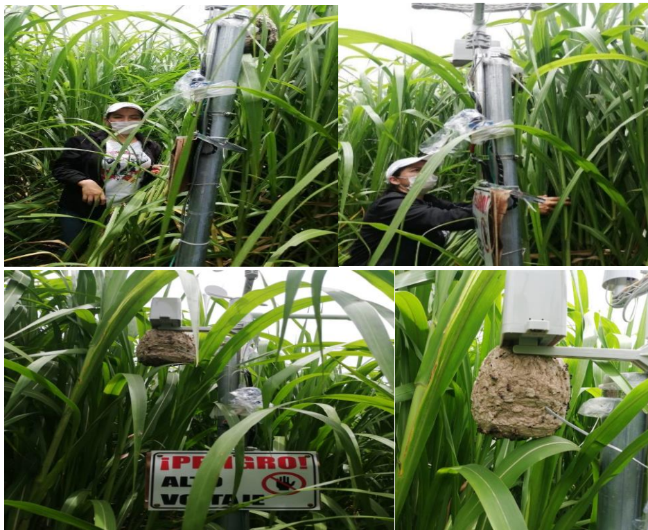
Imagen 62. Procedimiento para el control del panal de avispas de la estación 6 (Pastera)
