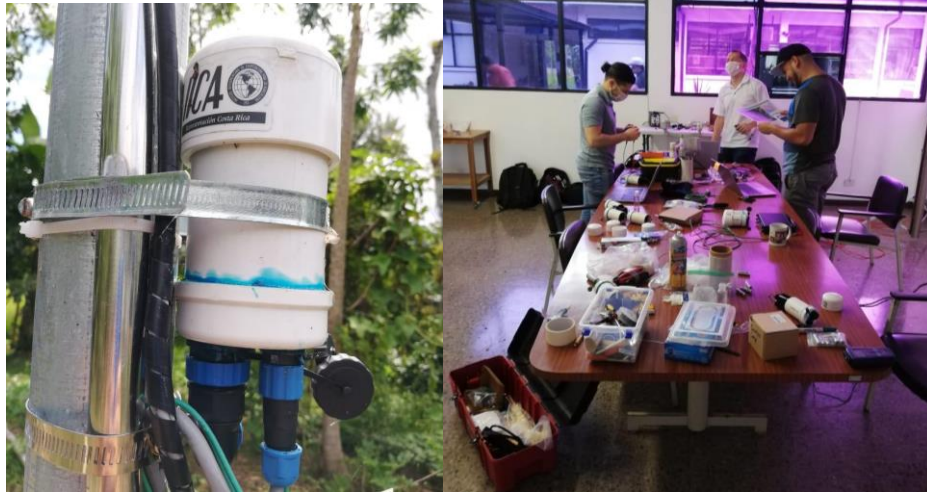
Imagen 61. Actualización del firmware y resellado en el campus CATIE
