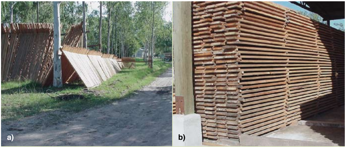
Fotos 2. Estibado horizontal (a) y en tijera (b) de la madera sobre polines de madera de 6"x6" y separadores de 1"x1" orientados verticalmente. Estos sistemas de estibado son los más comunes en la pequeña y mediana industria de la madera en Siguatepeque y San Pedro Sula.
