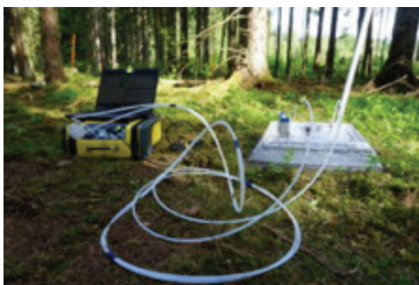
■ Figura 18. Equipo de medición de flujo de gases del suelo de la marca Gaset
