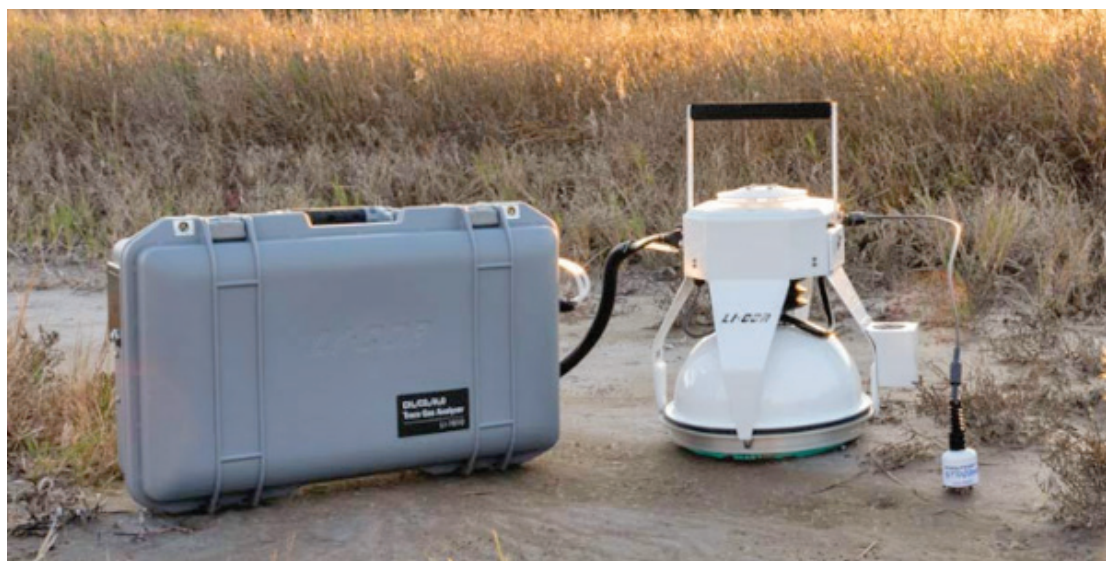
■ Figura 17. Equipo de medición de flujo de gases del suelo de la marca Li-Cor
