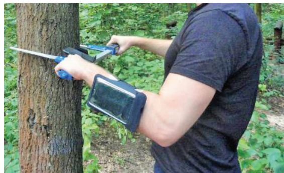
Figura 1. Uso de forcípula electrónica compatible con sistema Android para teléfonos móviles
