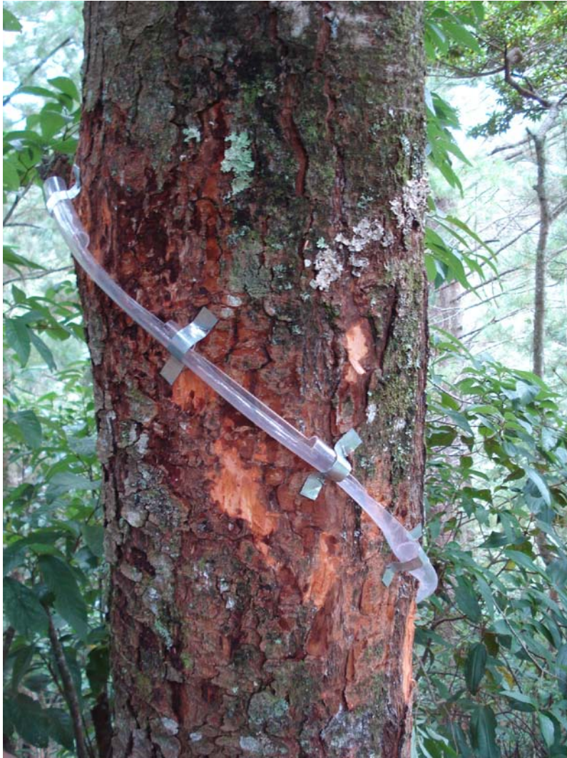
Figura 5. Manguera para recolección de escurrimiento del tronco
