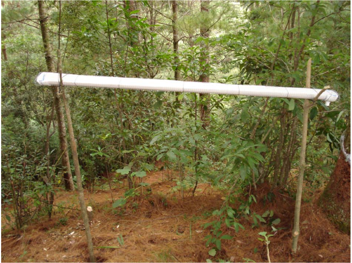
Figura 4. Pluviómetro horizontal o canoa utilizada.
