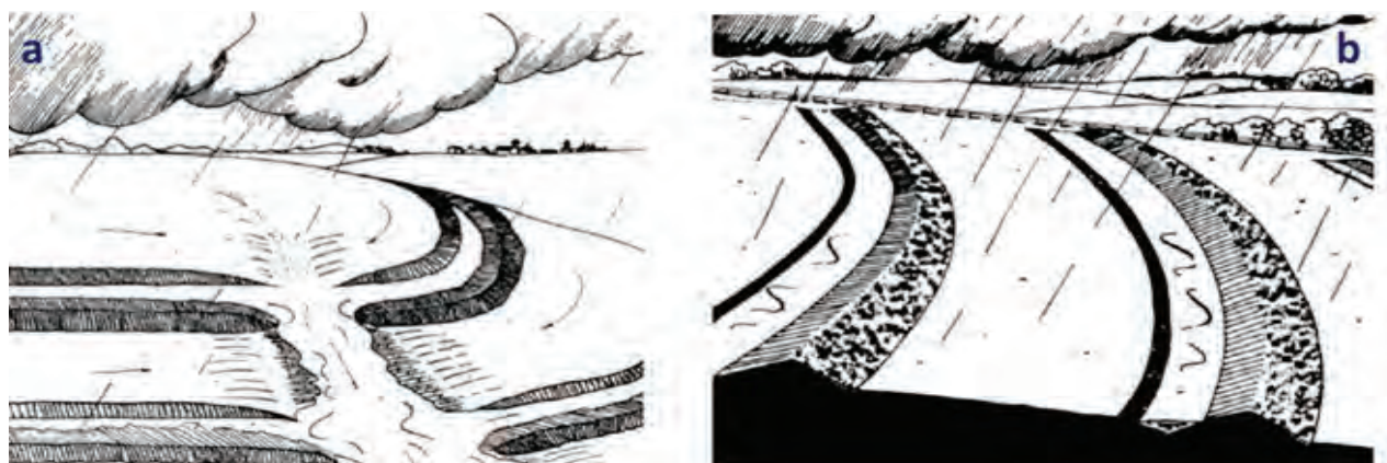
Figura 1. a. Terrazas a declive que muestra el desagüe hacia un cauce empastado. b. Terrazas a Nivel.
