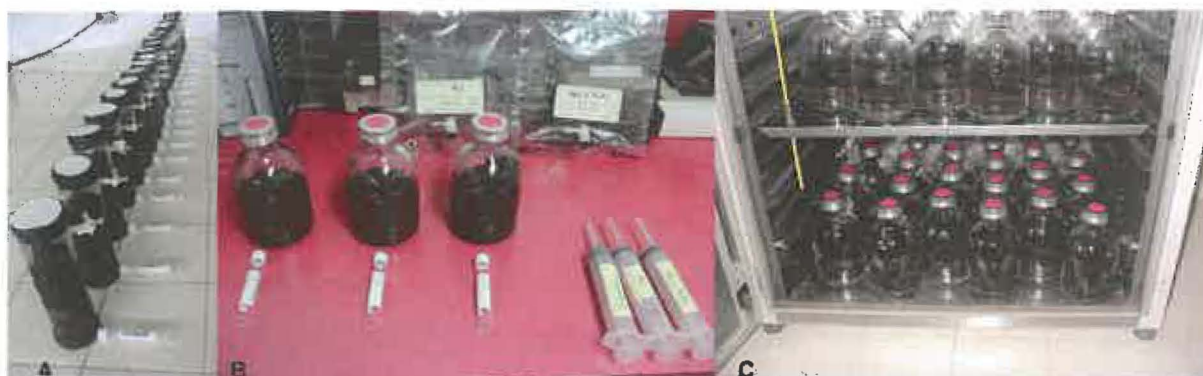
Figure I.11 : Cylindres de sol non remaniés placés dans des tubes hermétiquement fermés (A), échantillons de sol remaniés placé dans des flacons hermétiquement fermés, prêts à être échantillonnés (B) et mis en incubation à une température déterminée, dans l'obscurité (C)
