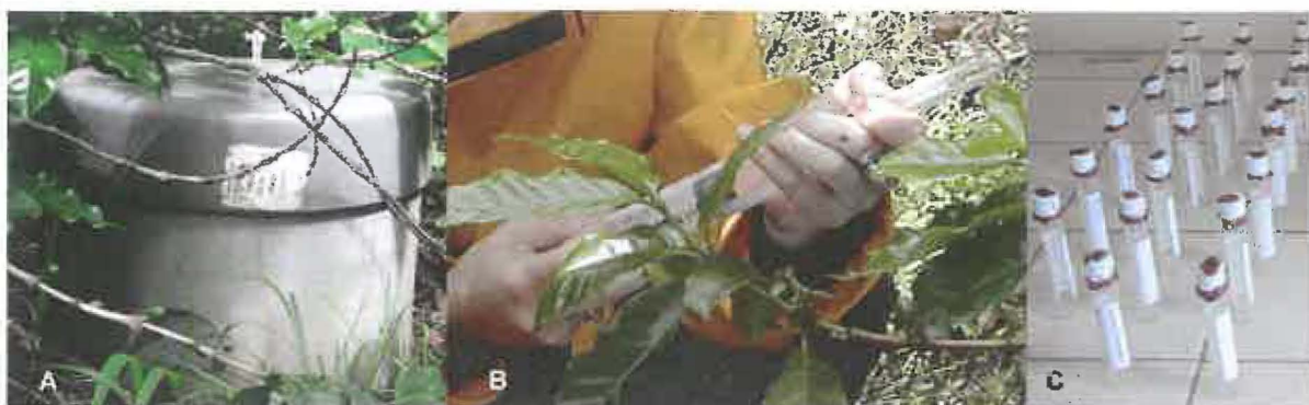
Figure I.10 Enceinte fermée placée au champ (A), injection d'un échantillon de gaz dans un tube (B) et tubes contenant les échantillons de gaz scellés pour transport au laboratoire
