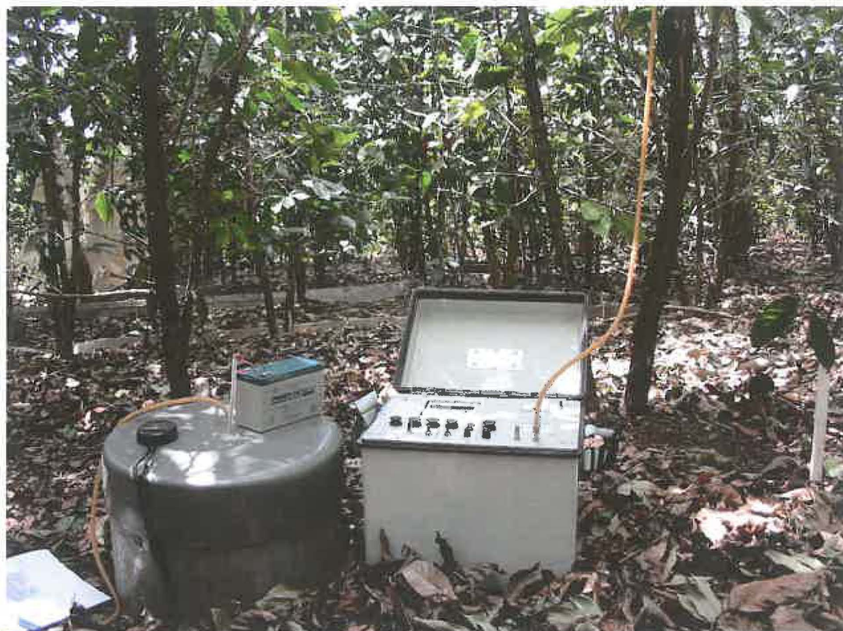
Figure II.1 : Dispositif expérimental de mesure des flux de GES à l'interface sol-atmosphère
