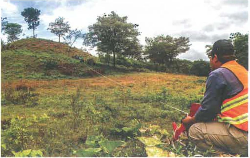
La medición de los altibajos del área y la medición y trazos del área para el reservorio, garantizan una labor apropiada de los que construyen la obra. Foto: CATIE.
