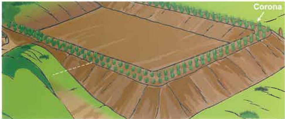
Figura 8. Corona del reservorio. Fuente CATIE 2015, p, 44.
