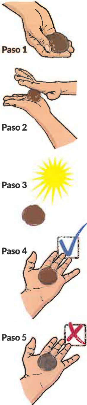
Figura 16. Pruebas con arcilla. Fuente CATIE 2015, p. 20.
