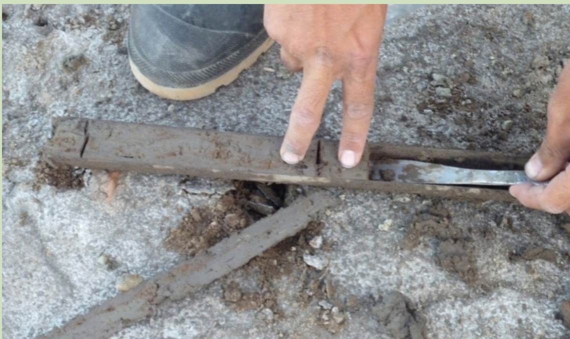
Figura 13. Demostración de la extracción de una muestra de suelo para determinar la densidad aparente del suelo del manglar y otros usos de la tierra.
