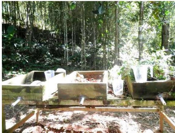
*Figura 7 Maquetas para experimento sobre cuencas hidrográficas*
