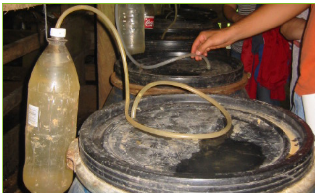
Salida de gases de un estañón, bidón o tonel plástico de fermentación donde la manguera sale del bidón para caer en una botella con agua (Foto: G. Soto).
