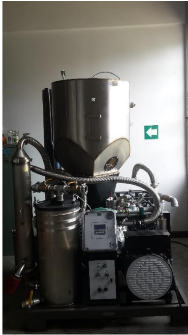
FIGURA 7. GASIFICADOR ALL POWER LABS DE 20W PERTENECIENTE AL TEC
