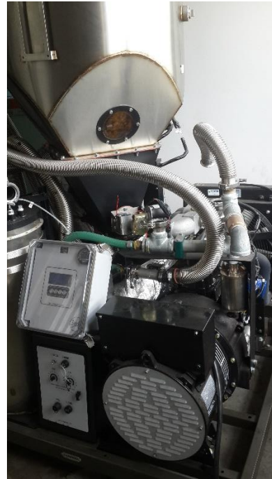
FIGURA 7. GASIFICADOR ALL POWER LABS DE 20W PERTENECIENTE AL TEC
