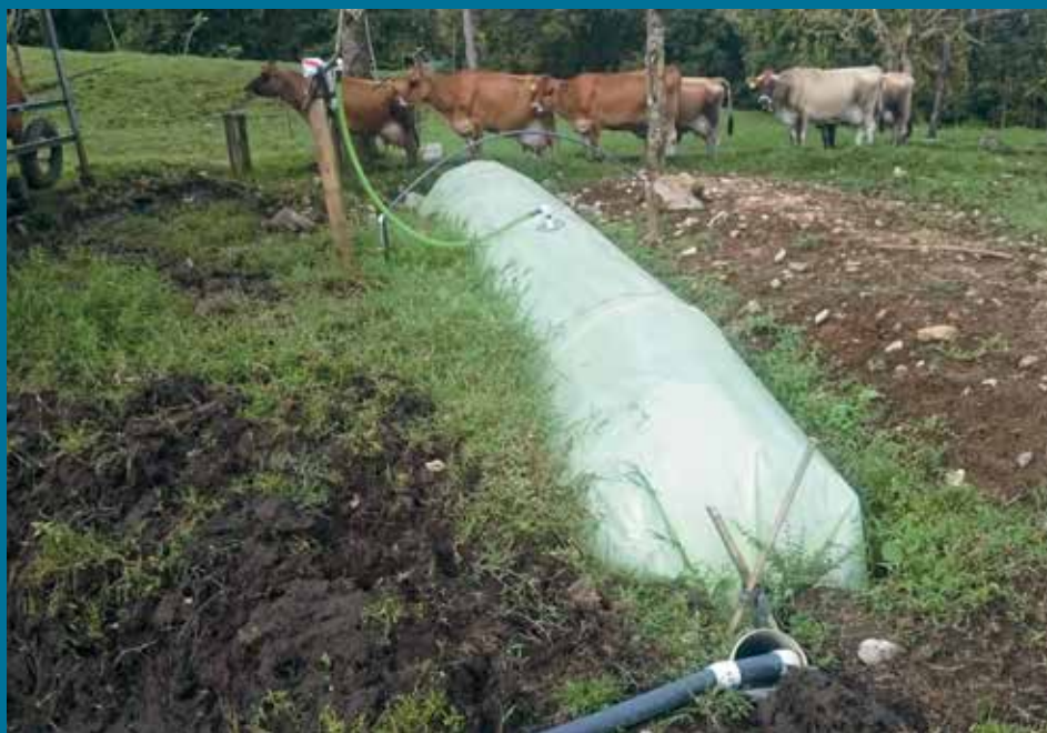
Biodigestor de flujo continuo construido en material de plástico para pequeñas explotaciones ganaderas.
