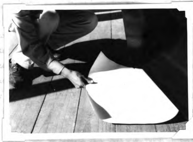
Fig. 13. Exposición del papel ozalid a vapores de amoníaco.
