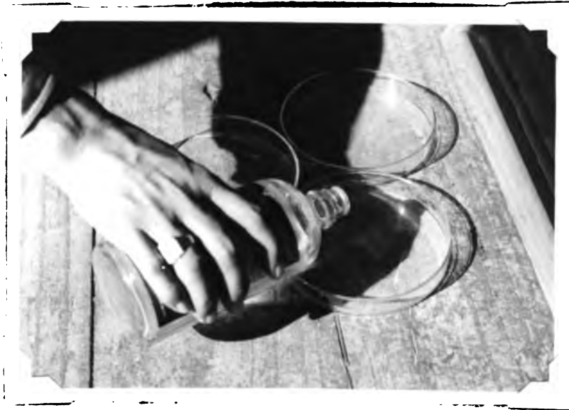
Fig. 12. Exposición del papel ozalid a vapores de amoníaco.
