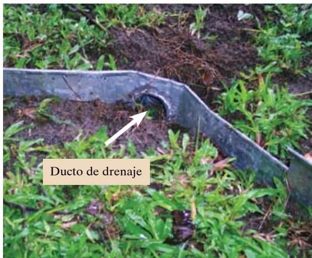
Figura 1. Sistema de recolección y drenaje de la parcela de escorrentía en Esparza, Costa Rica
