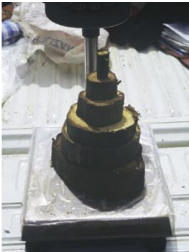
Medición del peso de muestras de tronco para secarlas posteriormente y calcular su contenido de humedad, finca Verde Vigor, Pérez Zeledón, Costa Rica (foto: Sergio de Miguel Magaña).
