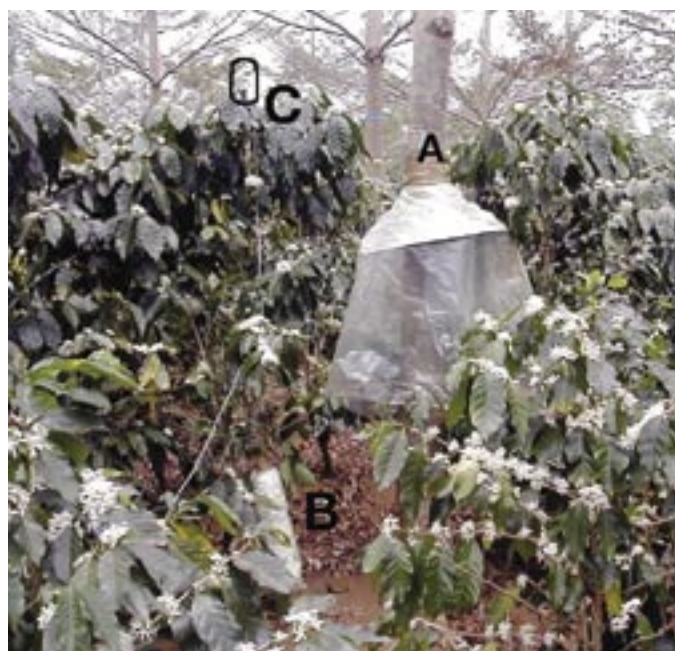
Equipo para medir el flujo de savia, instalado en Terminalia ivorensis [A] y Coffea arabica [B], así como una celda para medir RAFA [C], instalada arriba del cafeto de medición (foto: R. van Kanten).
